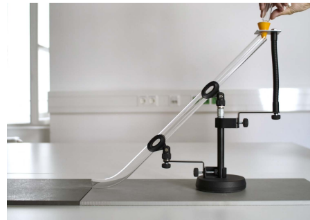
Abb.: Das Streumuster zeigt die Rutschfestigkeitsklasse des Bodens (li). Prototyp des Boden-Gleitprüfers der TU Wien mit einer Höhe von ca. 20 cm (re).
